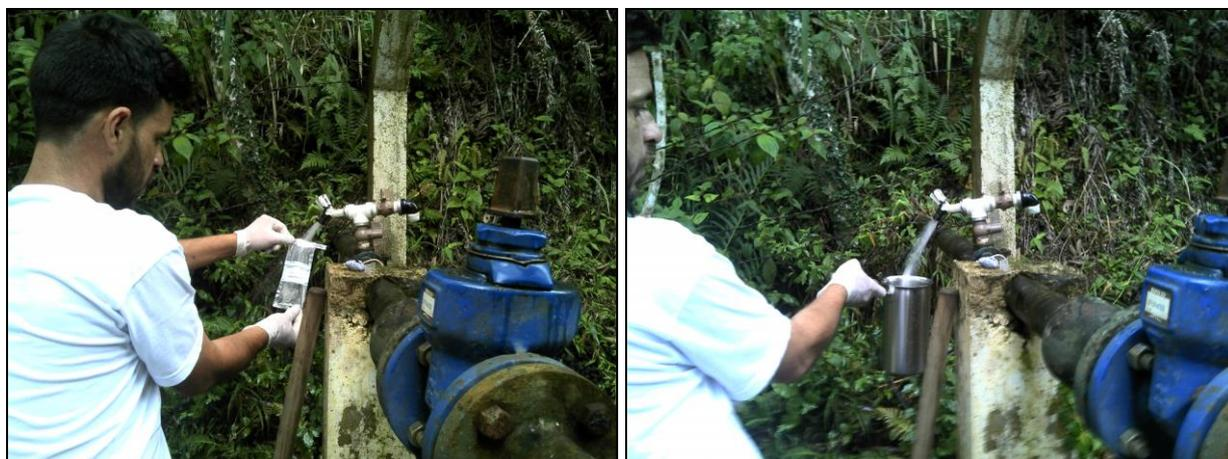
Figura 1: Coleta de amostra de água bruta na entrada da ETA
